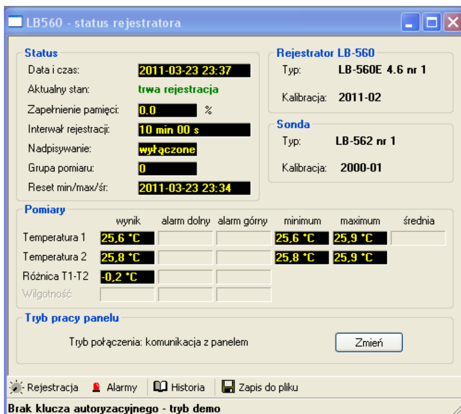
Rys. 4 Przykładowy widok okna (statusu) w programie LOGGER po podłączeniu termometru LB-560E z sondą LB-562
