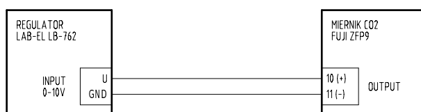
Rysunek 3.3: Schemat podłączenia miernika typu FUJI ZFP9
