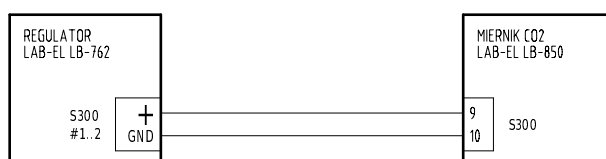
Rysunek 3.4: Schemat podłączenia miernika typu LAB-EL LB-850
