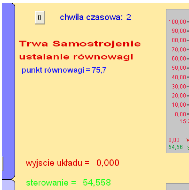
Rys. 10.10a Ekran samostrojzenia – ustalanie równowagi
