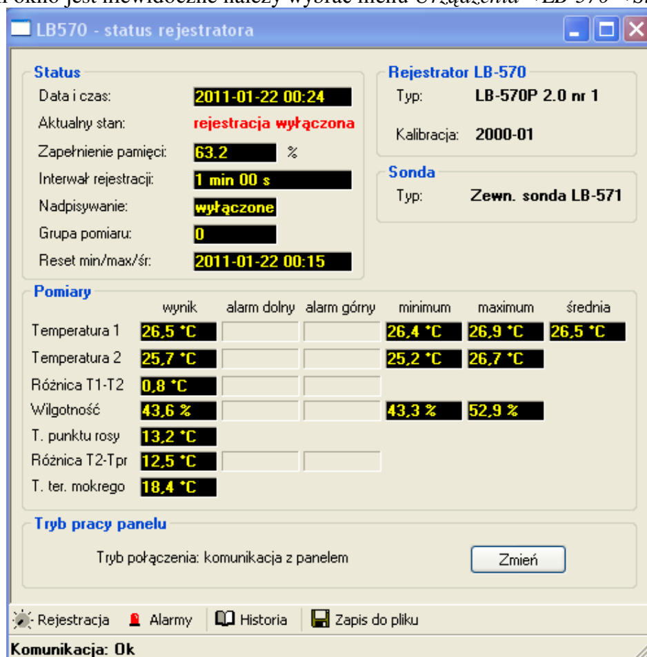
Rys. 4 Przykładowy widok okna (statusu) w programie LOGGER po podłączeniu termohigrometru LB-570P
