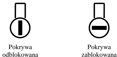
Rysunek 10 - zabezpieczenie pokrywy regulatora przed otwarciem
