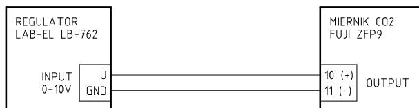
Rysunek 3.3: Schemat podłączenia miernika typu FUJI ZFP9
