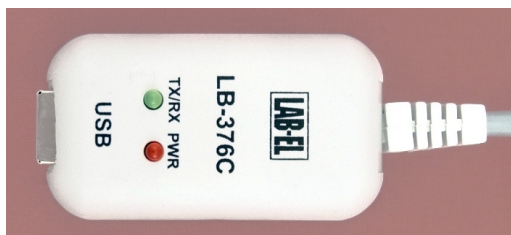
Rysunek 3 Konwerter LB-376C – do podłączenia sondy do komputera poprzez interfejs USB
