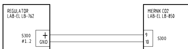
Rysunek 3.4: Schemat podłączenia miernika typu LAB-EL LB-850
