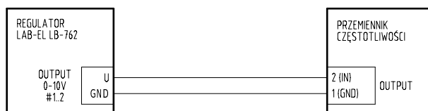
Rysunek 3.12: Schemat podłączenia przemiennika częstotliwości typu OBRUSN PC3.., OBRUSN PC4.., SSD Drives 605, SSD Drives 650 i podobnych
