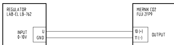
Rysunek 3.3: Schemat podłączenia miernika typu FUJI ZFP9
