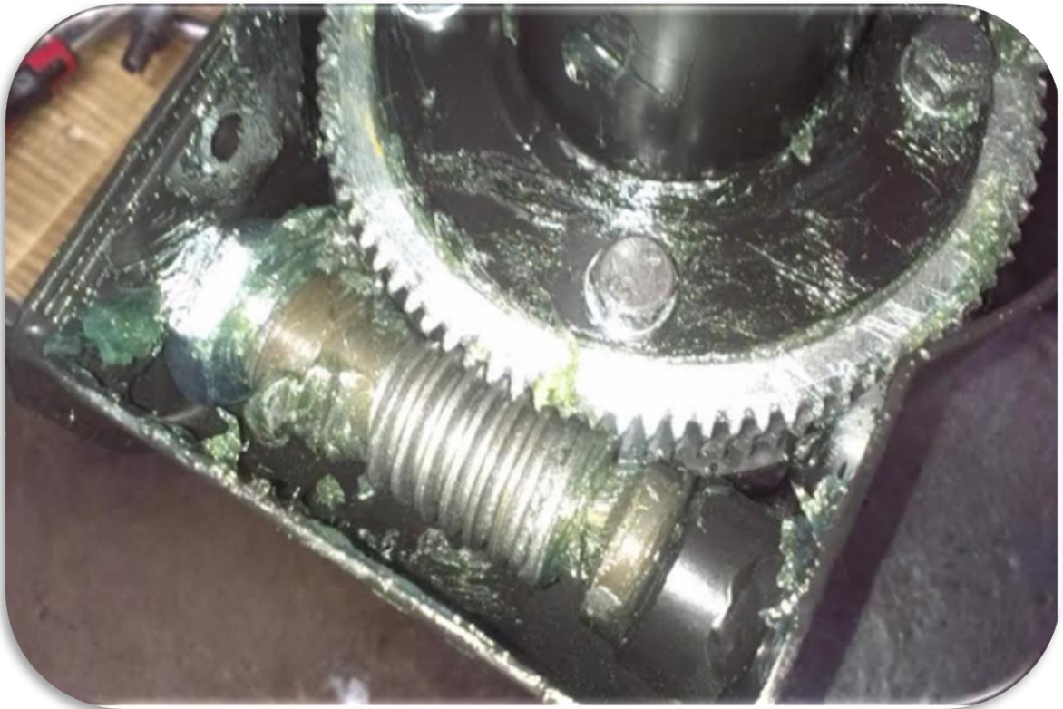
Rys. 6. Przekładnia ślimakowa obrotnicy [27]
