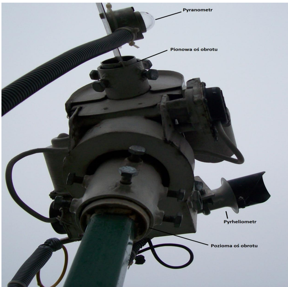
Rys. 5. Obrotnica RAS wraz z zamontowanymi na niej urządzeniami [fot. Własne]
