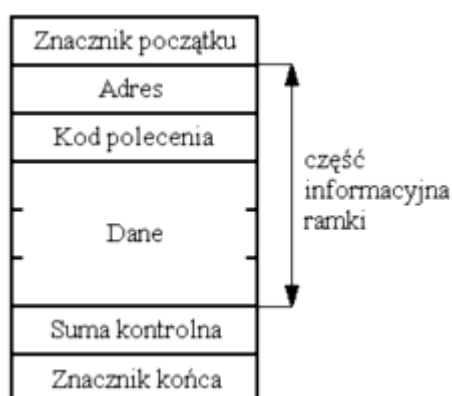
Rys. 9.2.2. Struktura ramki sieci Modbus.
