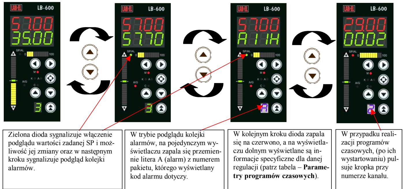
Rys. 4.2 Przełączanie wielkości wyświetlanych na dolnym wyświetlaczu
