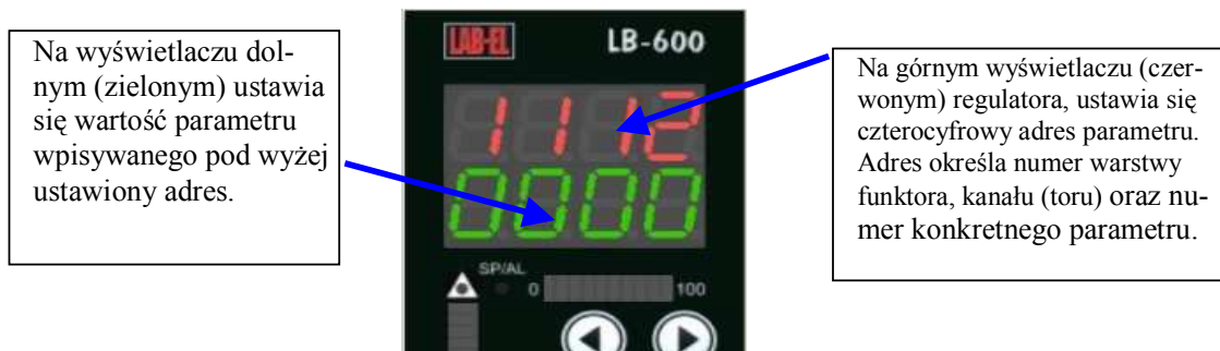
Rys. 5.1 Opis wyświetlanych informacji w trybie programowania
