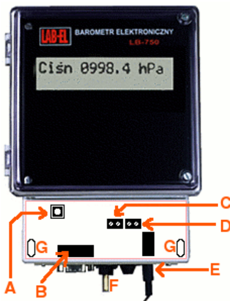
Rysunek 1: Punkty manipulacyjne w komorze złącz: A – przycisk menu przyrządu, B – gniazdo portu A: RS-232C oraz RS-485, C – zaciski portu B: S300, D – zaciski zasilania 12V/DC, E – gniazdo zasilania 12V/DC, F – doprowadzenie medium, G – otwory mocowań
