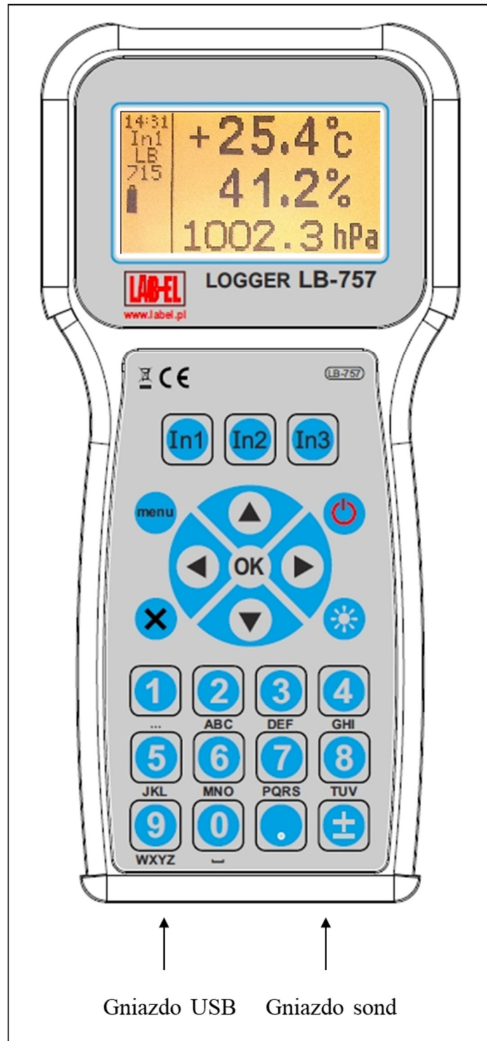
Rys. 1 Rejestrator LB-757 – widok od strony klawiatury
