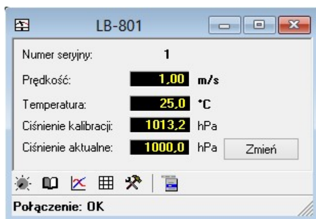
Rysunek 10 Przykładowe okno programu LBX po podłączeniu czujnika LB-801 (z włączoną kompensacją ciśnienia atmosferycznego) – po konfiguracji
