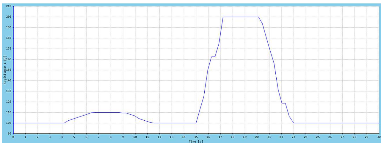
Rys 12: Czas ustalania wskazania: około 3s (zasymulowano zmiany temperatury 25°C i 266°C)
